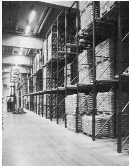
4: Schubmaststapler bei der Einfahrt ins Drive-in-Regal
