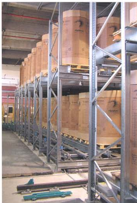
Das Kompaktlager mit zwei Ebenen konnte Infracor in vorhandenes Flachlager einbauen.
